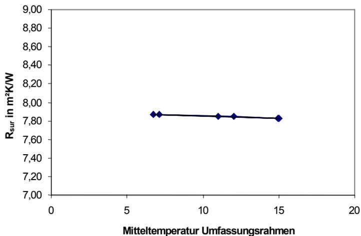
**Bild 2** Wärmedurchlasswiderstand Umfassungsrahmen
